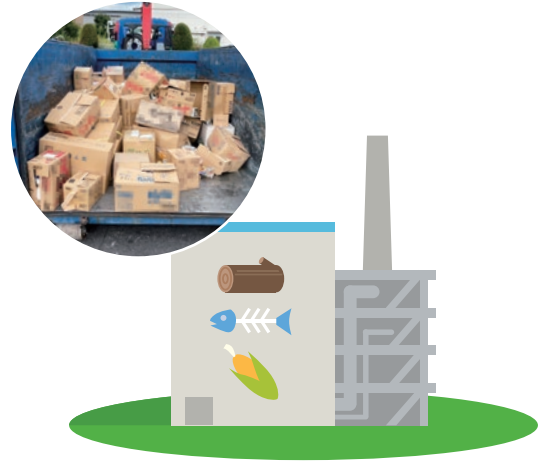
▲食品由来の廃棄物等を原料としてメタン発酵を行い、発生したバイオガスを燃料にバイオガス専焼発電機で発電する仕組み
