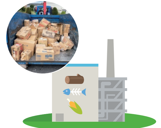
▲食品由来の廃棄物等を原料としてメタン発酵を行い、発生したバイオガスを燃料にバイオガス専焼発電機で発電する仕組み
